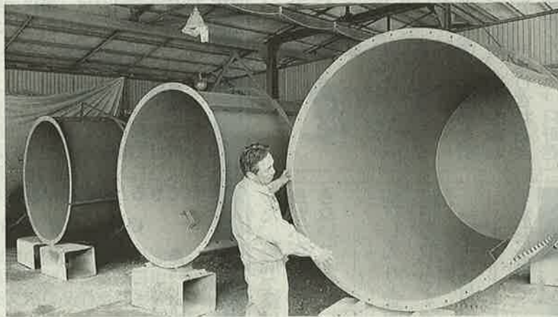
バイオガス発電に使う鉄製タンク。成長分野として期待が高まる
